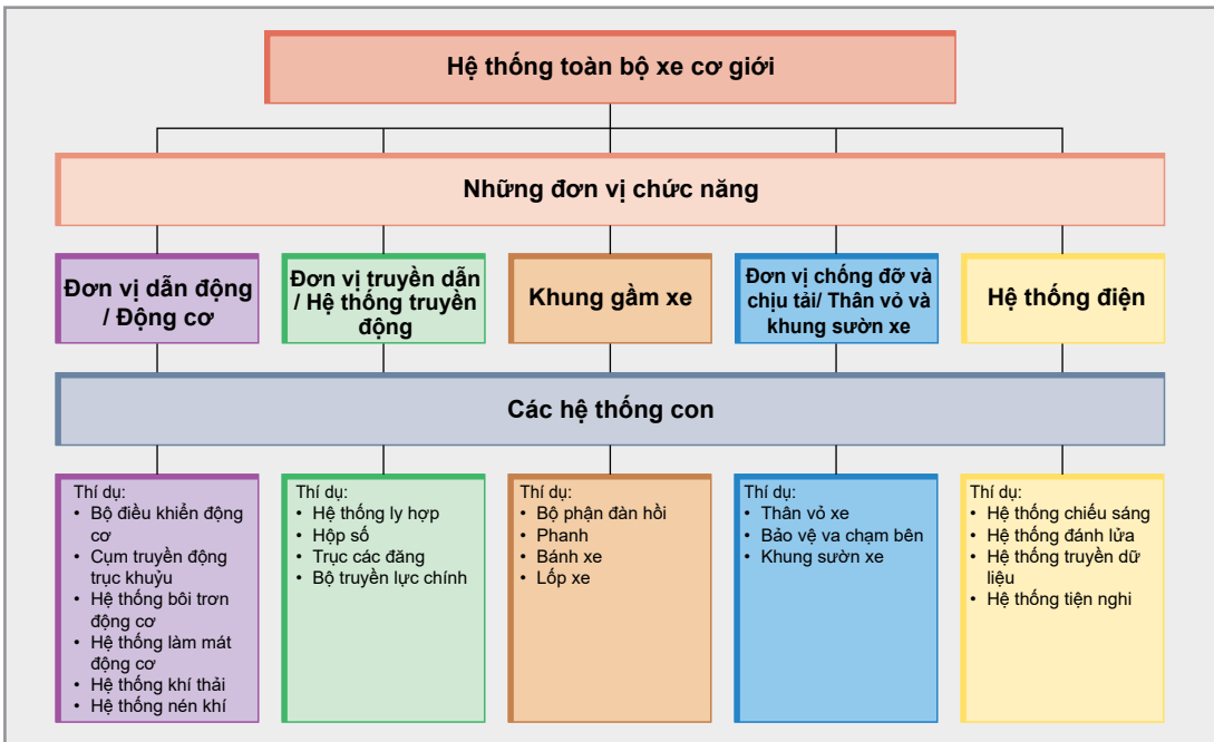
Hình 1: Liên kết hệ thống của xe cơ giới
