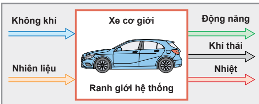
Hình 2: Sơ đồ tổng quát về hệ thống với thí dụ xe cơ giới
