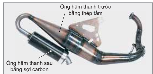
Hình 4: Bộ xả khí thải xe đua cho xe scooter
