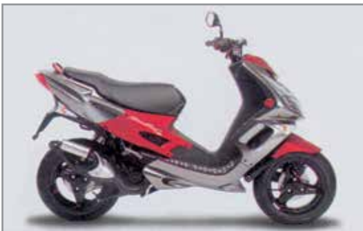
Hình 1: Xe scooter (scooter thể thao, 49 cm 3 , 3,2 kW)
