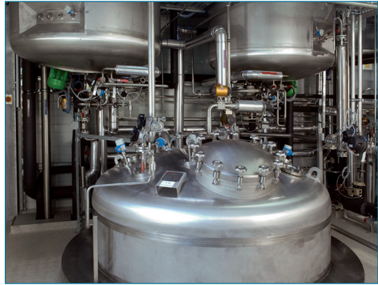
Hình 2: Các thùng chứa môi trường dinh dưỡng lên men trong sản xuất công nghiệp sinh học
