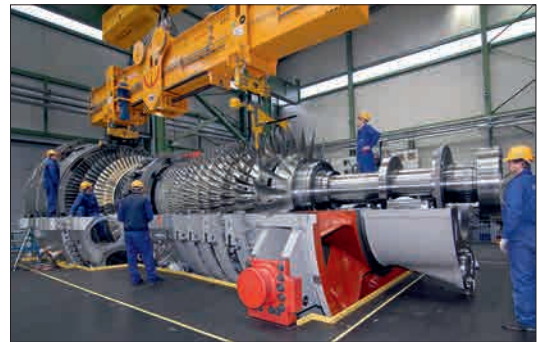
Hình 3: Rotor của một tuabin khí Hình phổ biến bởi Siemens www.siemens.de
