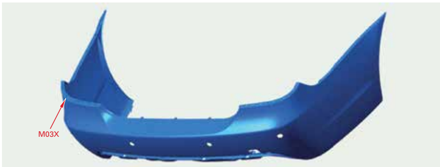
Hình 2: Điểm đo M03X tại phần phía sau một bộ phận ô tô
