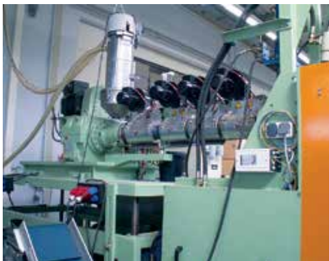
Hình 2: Máy đùn nối tiếp với máy thổi khuôn
